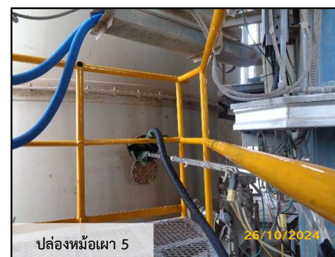
ภาพที่ 3.18 การตรวจวัด TOC จากปล่องหม้อเผา
