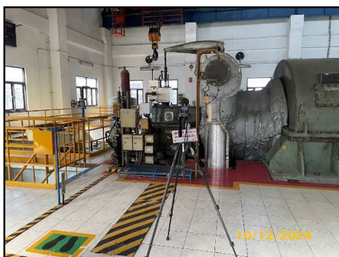
ภาพที่ 3.47 การตรวจวัดระดับเสียงของ เครื่องจักรบริเวณกังหันไอน้ำ
