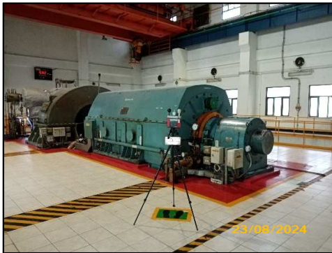
ภาพที่ 3.58 การตรวจวัดความร้อน บริเวณเครื่องกำเนิดไฟฟ้า
